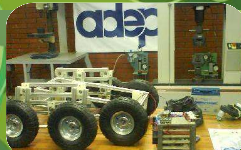
Elementos de estructura de robot, tarjetas electrónicas modulares, estructura y sistema de motores.
